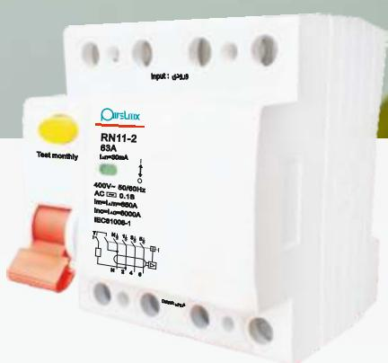
کلید محافظ جان، جریان نشستی کوچکی که فیوز قادر به شناسایی آن نیست را شناسایی میکند و مدار را در چند دهم یا چند صدم ثانیه قطع میکند.
